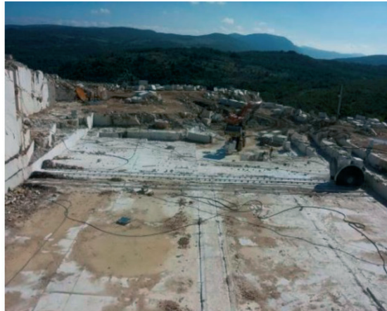
b) stroj s reznim diskom u radu na etaži
