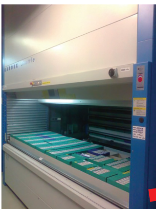
Elektronski ormar za pohranu kaseti
