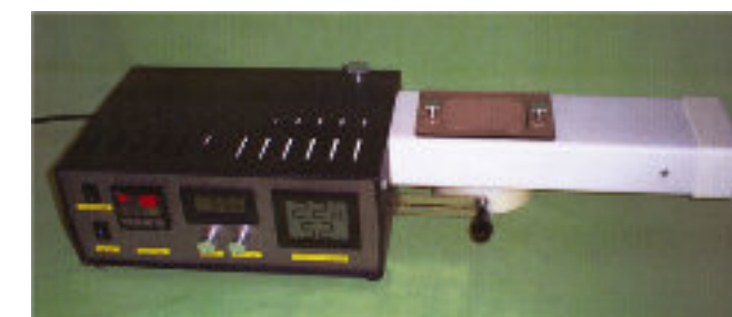
Slika 1: PERMETEST – Uređaj za nedestruktivno određivanje otpora prolazu topline i otpora prolazu vodene pare, tt. SENSORA Instruments [17]
