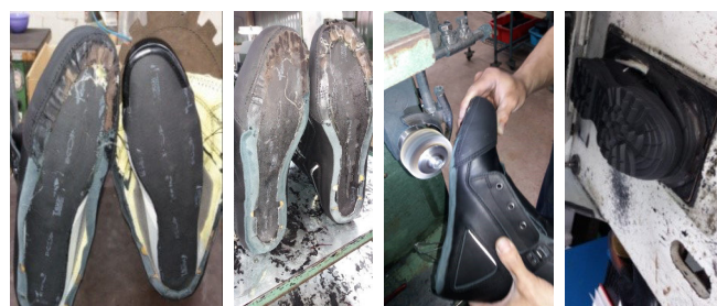
Slika 12 Navlačenje vrška – cvikanje
