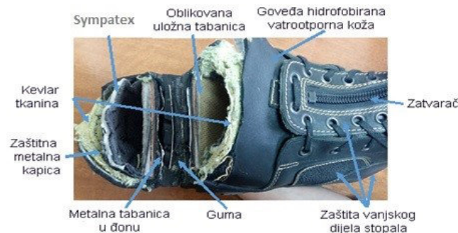
Slika 6. Čizma za šumare prikazana po slojevima
