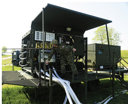
Slika 12. ROWPU sustav - pustinjska verzija (lijevo) i zelena verzija na uporabi u OSRH-u (desno)
