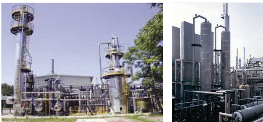
Slika 10. Primjeri sustava za oksidaciju mokrim zrakom Izvor: Oil and Gas online (2018) i Siemens Energy (2009)
