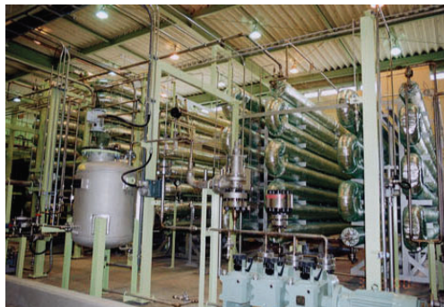
Slika 11. Primjeri sustava za oksidaciju superkritičnom vodom Izvor: National Academy of Engineering (2013) i Cabeza i sur. (2014)
