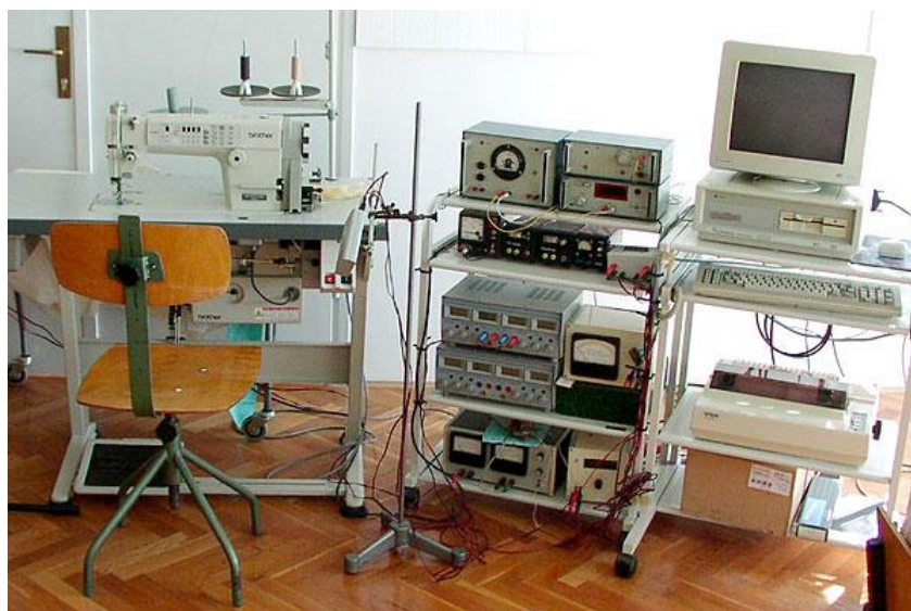
Sl. 1. Sustav za automatska mjerenja procesnih parametara i struktura tehnoloških operacija proizvodnje odjeće spojen za prihvat procesnih parametara s industrijskog šivaćeg stroja
