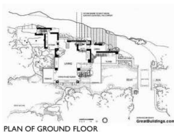
Slika 14. Tlocrt prizemlja kuće Fallingwater
