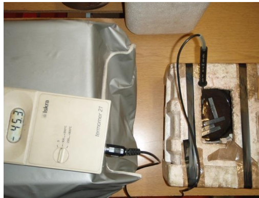
Slika 15. Podhlađivanje uzoraka u smjesi suhoga leda i alkohola (Vusić, 2015.)
