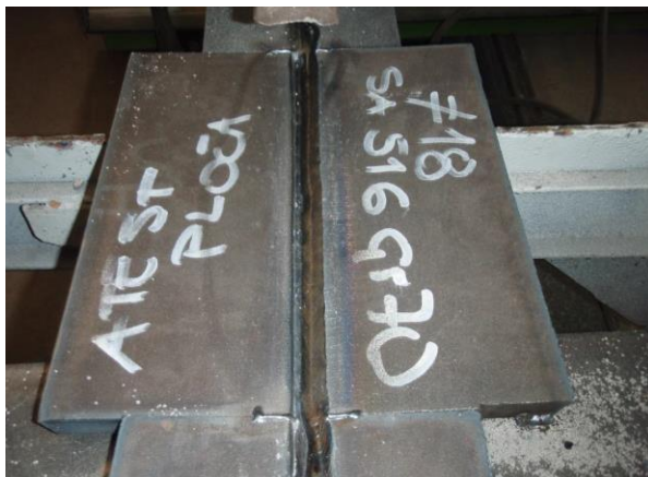
Slika 6. Zavareni spoj nakon 5. prolaza, popuna spoja vrši se u dva prolaza (Vusić, 2015.)
