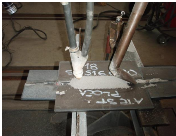
Slika 5. Prikaz EPP zavarivanja sučeljenog spoja iz osnovnoga materijala SA516 Gr70 (Vusić, 2015.)
