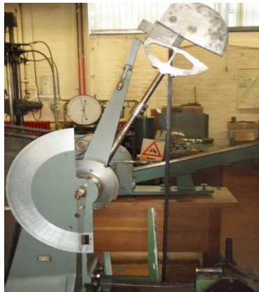
Slika 9. Charpy – ev bat na kojem je mjeren udarni rad loma (Vusić, 2015.)
