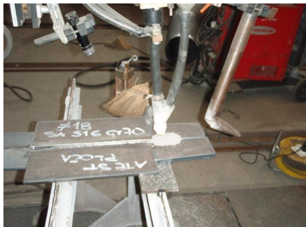
Slika 3. Uspostava električnog luka kod EPP zavarivanja (Vusić, 2015.)
