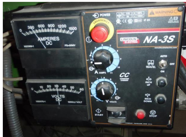
Slika 4. Vrijednosti struje i napona prilikom EPP zavarivanja (Vusić, 2015.)
