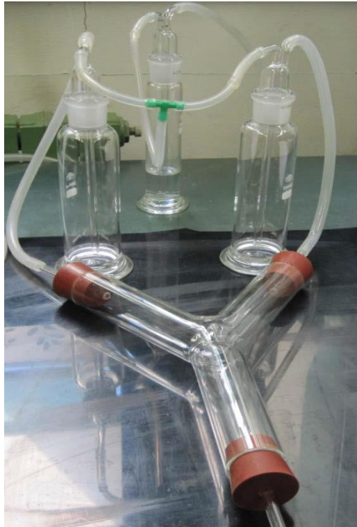
Slika 4. Y-olfaktometar korišten u istraživanju (Izvor: AbuAssaf, 2013) Figure 4 Y-olfactometer used in experiments (Source: AbuAssaf, 2013)
