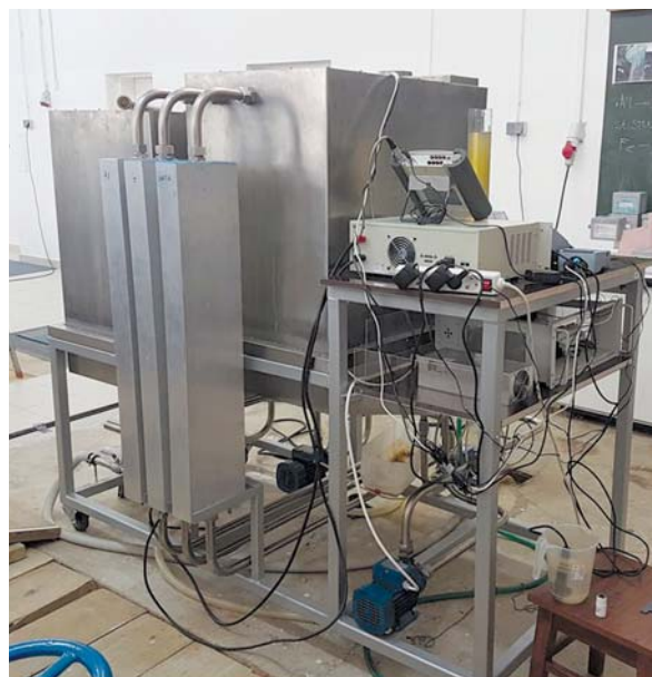
Slika 1: Elektrokoagulacijski pilot uređaj instaliran u Hidrotehničkom laboratoriju Građevinskog fakulteta Sveučilišta u Zagrebu, (lijevo - slika uređaja s prednje strane, desno - slika uređaja sa stražnje strane)
