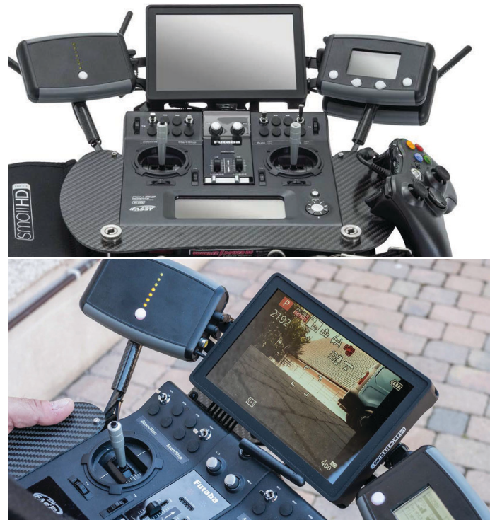
Slika 2.2. Bazna jedinica za daljinsko upravljanje (Topcon 2015)
