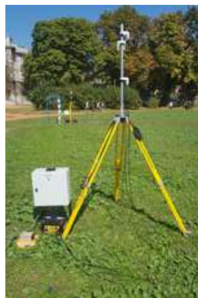
Slika 2. LocataLite primopredajnik spojen na 3 antene postavljene na nosač fiksiran na stativu
