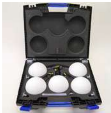
Slika 2. Mjerne mete – sfere
