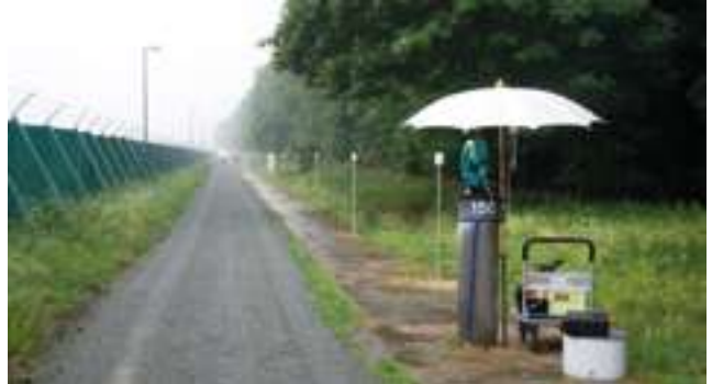
Slika 3.5. Geodetska bazna linija PTB, Braunschweig, opremljena meteorološkim sensorima (Jokela, 2014).
