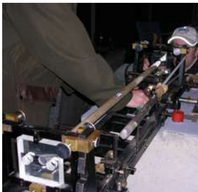
Slika 2.7. Interferometar Väisälä postavljen na stupovima 0 i 1, s kvarcnim etalom br. VIII (Jokela i dr., 2009).
