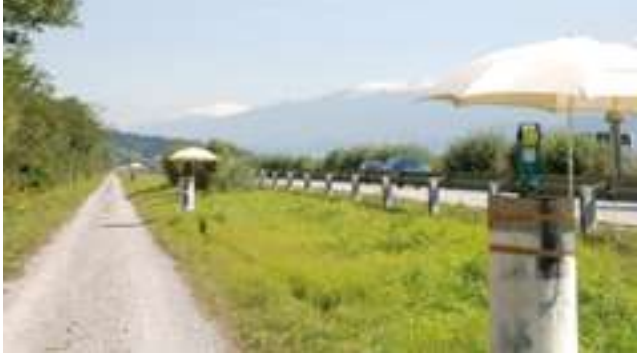
Slika 3.4. Kalibracija baze BEV u Innsbrucku pomoću KERN Mekometra ME5000 (Jokela, 2014).
