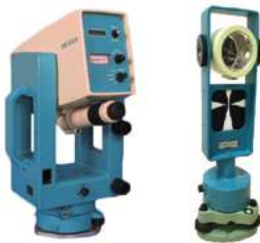
Slika 3.1. Kern Mekometer ME5000 i reflektor Kern RMO5035 (Dvořáček, 2012).
