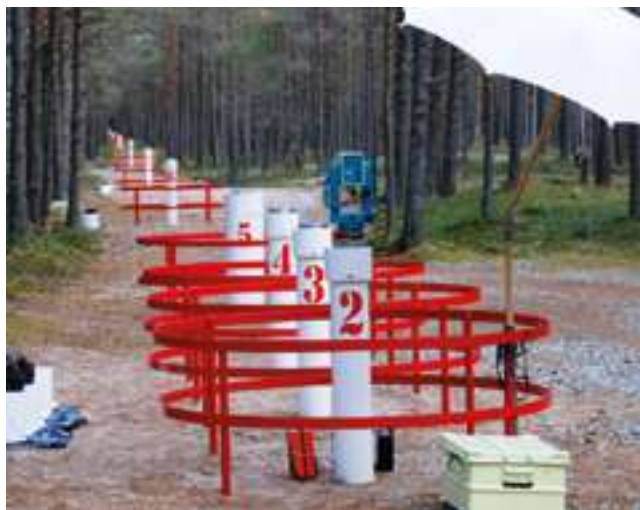
Slika 3.3. Kern ME5000 na kalibracijskoj bazi Vääna (Jokela, 2014).
