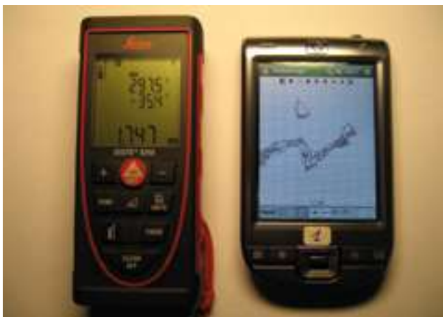
Slika 7. Sustav DistoX za digitalnu izmjeru speleoloških objekata
