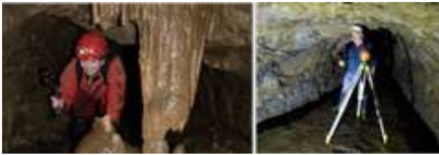
Slika 10. GeoSLAM pri mjerenju špilja
