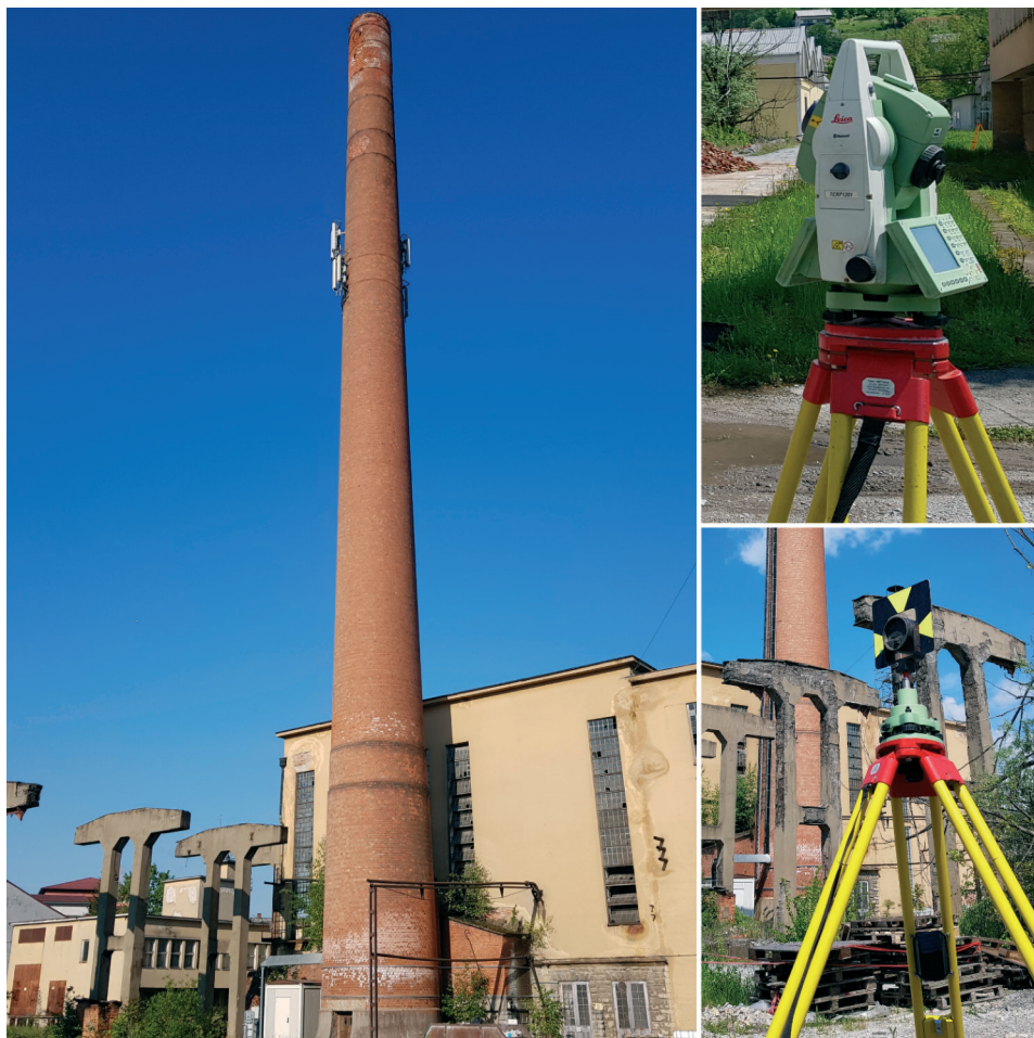
Slika 3. Dimnjak te upotrijebljeni instrument (Leica TCRP1201) i pribor (Polović 2019).
