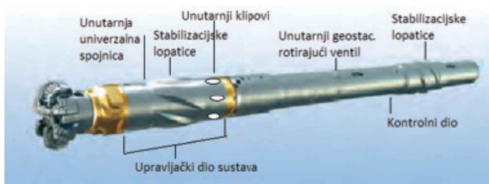
Slika 7. Hibridni rotirajući upravljivi sustav (Felczak i drugi, 2012)
