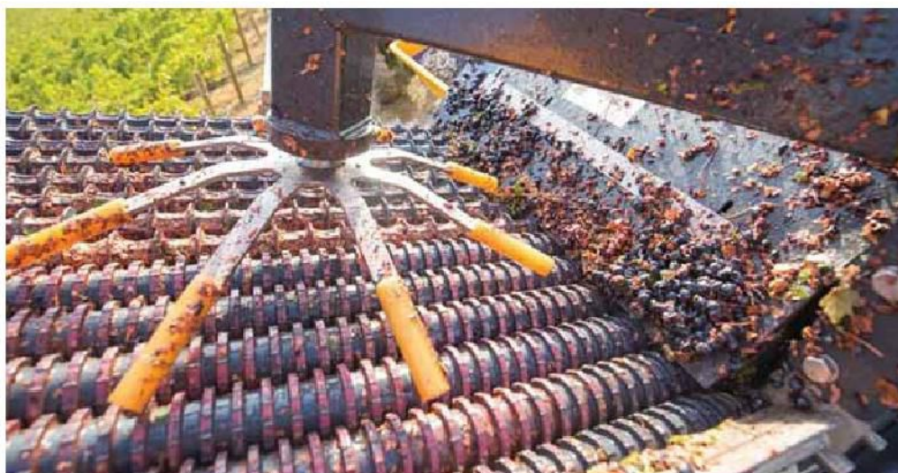
Slika 2. Valjčani niz uklanja lišće i ostale nečistoće te ih ostavlja uz rub vinograda.
