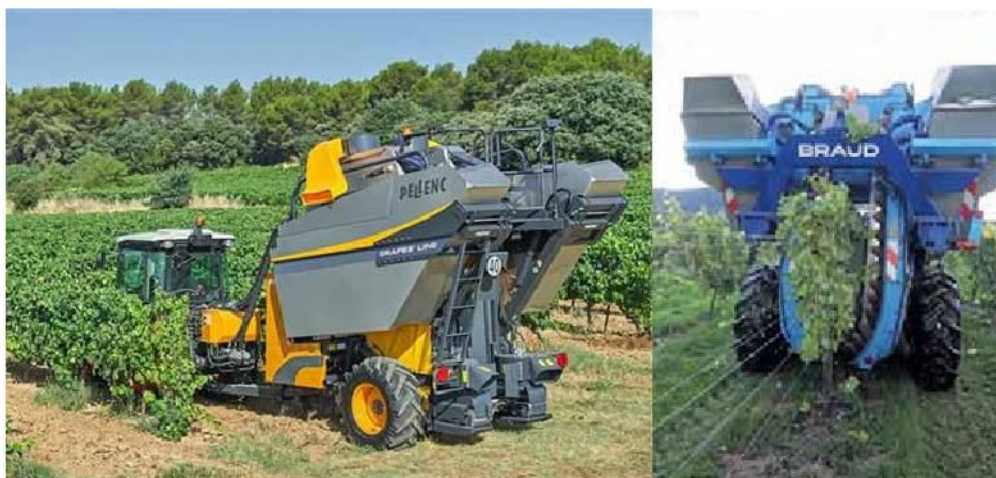
Slika 3. Suvremeni vučeni (Pelenc) te samohodni kombajn za branje grožđa (Braud). Figure 3. Contemporary towed (Pelenc) and self-propelled grape harvester (Braud).
