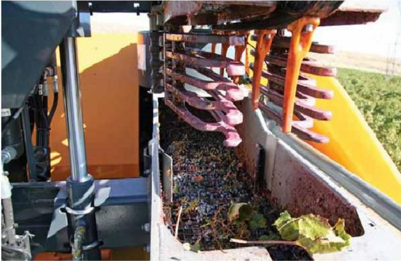
Slika 4. Šipke slične prstima, koje se nalaze na vrhu kombajna, razbijaju male grozdove i pomažu u oslobađanju bobica iz stabljika
