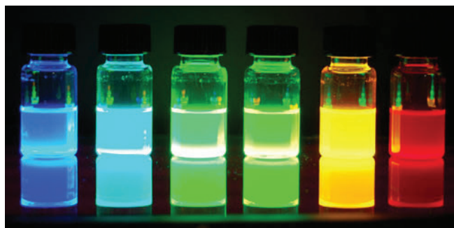
Slika 4 – Fotoluminiscencija modificiranih kvantnih točki \text{CdS}_x\text{Se}_{1-x}/\text{ZnS} promjera 6 nm. Podešavanjem sastava materijal emitira različitu boju svjetlosti (izvor: https://www.sigmaaldrich.com )
