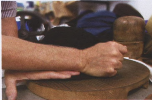
4. I rukama se zaribava kako bi se apretura što bolje upila u pust (file). 5. Obrezivanje krila šešira šnajpretlom. 6. Krilo šešira pritišće se drukholcom i tako oblikuje rub šešira (banštel). 7. U fazi opremanja šiva se vrpca na šeširu. 8. Napareni šešir rukama se oblikuje prije navlačenja na kalup. 9. Zatezanje šešira užetom pomoću trajbajsa kako bi zadržao svoj oblik za vrijeme parenja i prešanja.
