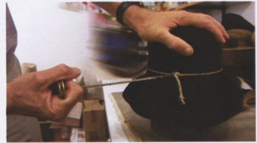
4. I rukama se zaribava kako bi se apretura što bolje upila u pust (file). 5. Obrezivanje krila šešira šnajpretlom. 6. Krilo šešira pritišće se drukholcom i tako oblikuje rub šešira (banštel). 7. U fazi opremanja šiva se vrpca na šeširu. 8. Napareni šešir rukama se oblikuje prije navlačenja na kalup. 9. Zatezanje šešira užetom pomoću trajbajsa kako bi zadržao svoj oblik za vrijeme parenja i prešanja.
