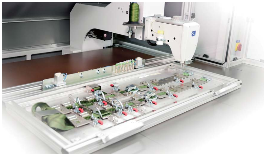
Sl.1 KL 310 CNC jedinica za šivanje materijala za velika opterećenja s površinom šivanja od 1000 x 600 mm
