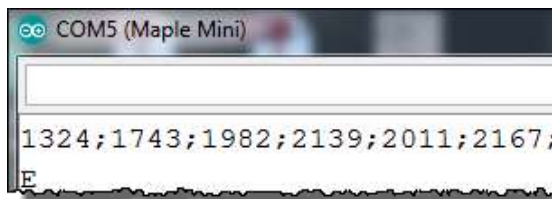
Slika 9. Primjer podataka CCD senzora koje šalje mikroupravljač
