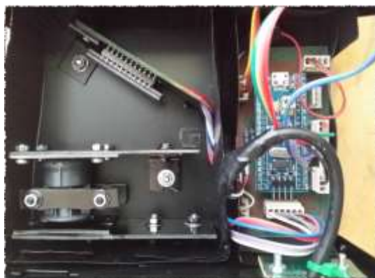
Slika 8. Unutrašnjost spektrometra s mikroupravljačem (desno)
