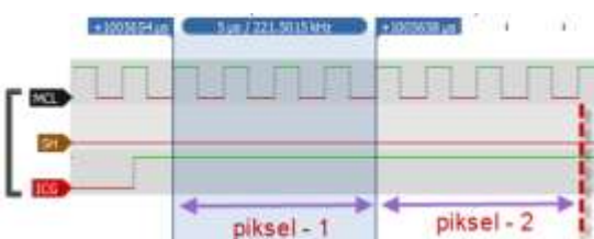
Slika 7. Očitavanje piksela CCD senzora
