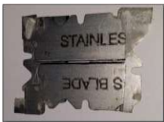
Slika 4. Pukotina izrađena od 2 žileta kroz koju prolazi ulazna svjetlost
