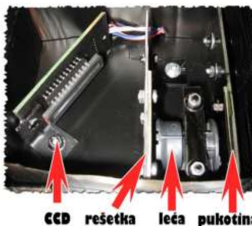
Slika 3. LCD unutrašnjost CCD spektrometra (CCD, optička rešetka, pukotina i leća)
