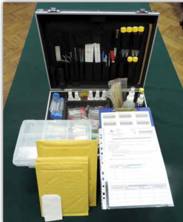
Slika 3. Set za uzimanje bioloških tragova koji sadržava slijedeće: rukavice za jednokratnu upotrebu, metalne i jednokratne plastične pincete, skalpele s izmjenjivim sterilnim nožićima, vatrane sterilne štapiće (obrisni štapići), stalak za sušenje izuzetih uzoraka, bočicu s pročišćenom destiliranom vodom, bočicu sa sredstvom za dezinfekciju, FTA – kartice, igle, brizgalice ili Vacutainer sustav s EDTA epruvetama, naljepnice za označavanje uzoraka s jedinstvenim barkodovima, papirnate vrećice različitih veličina za pohranu uzoraka, plastične sterilne posudice različitih veličina za pohranu uzoraka, pribor za pisanje i označavanje te upute za prikupljanje različitih bioloških tragova/dokaza
