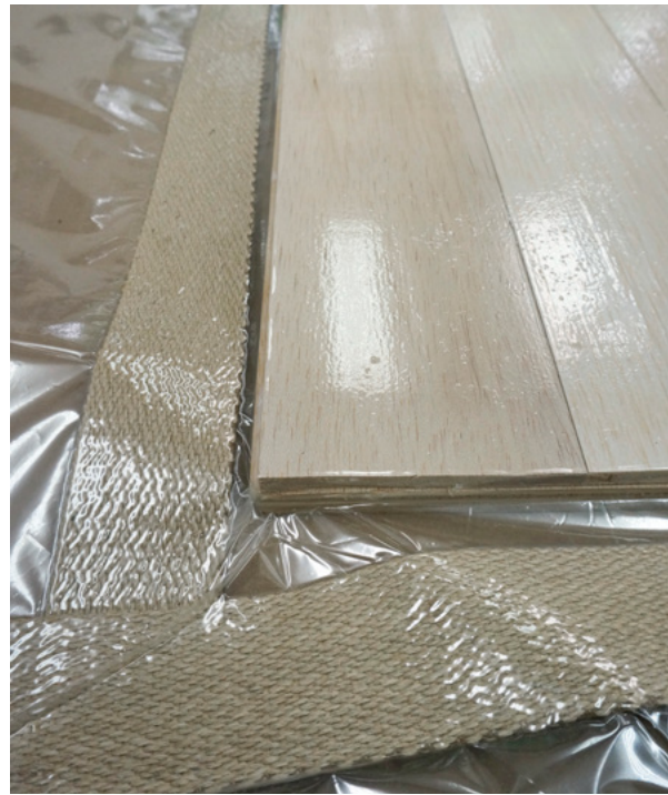
16. Lijepljenje balze za vodootporna šperploču djelovanjem podtlaka (fototeka HRZ-a, snimio O. Šuman, 2016.) Gluing balsa boards onto waterproof plywood under pressure (Croatian Conservation Institute Photo Archive; O. Šuman, 2016)
