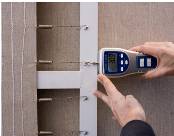
16. Mjerenje napetosti opruga (fototeka HRZ-a, snimio Lj. Gamulin, 2014.)
