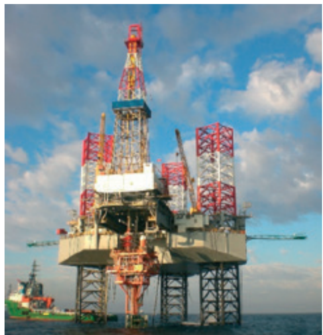
Slika 11. Samopodizuća bušača platforma Ocean King za vrijeme izrade bušotine Ika B3 HOR u simop načinu
