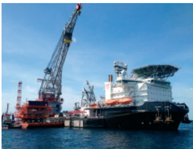
Slika 8. Oleg Strashnov tijekom instaliranja palube proizvodne platforme Ika JZ
