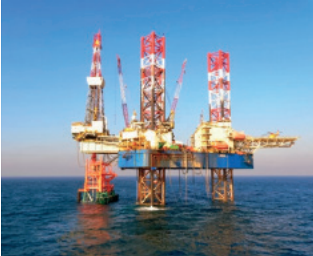
Slika 3. Samopodizuća bušača platforma Labin / Croscio
