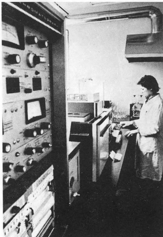
Fizikalno-biokemijski laboratorij »Podravke«, kontrola pesticida plinskom kromatografijom 1984. godine
