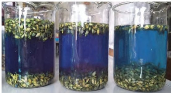
Slika 4. Potapanje obojenog zrna ječma u otopinu natrijevog hidroksida (foto: Galešić, M. A.)
