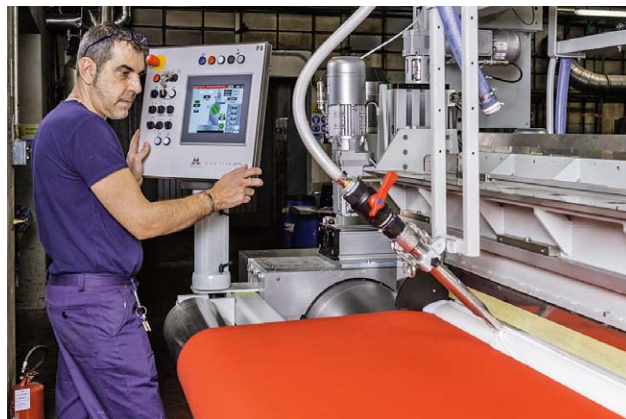
Sl.2 Izuzetna fleksibilnost texCoat jedinice – primjer iz prakse u talijanskoj tvrtki Mariani koja omogućuje provođenje naslojavanja rastiralom preko zraka i preko valjka za naslojavanje pomoću jednostavne PCL tehnike
