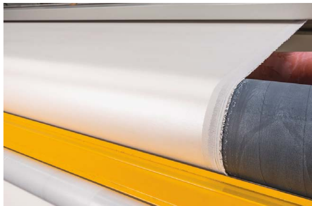
Sl.1 A Monforts texCoat jedinica s magnetskim naslojavanjem – primjer primjene u njemačkoj tvrtki van Clewe
