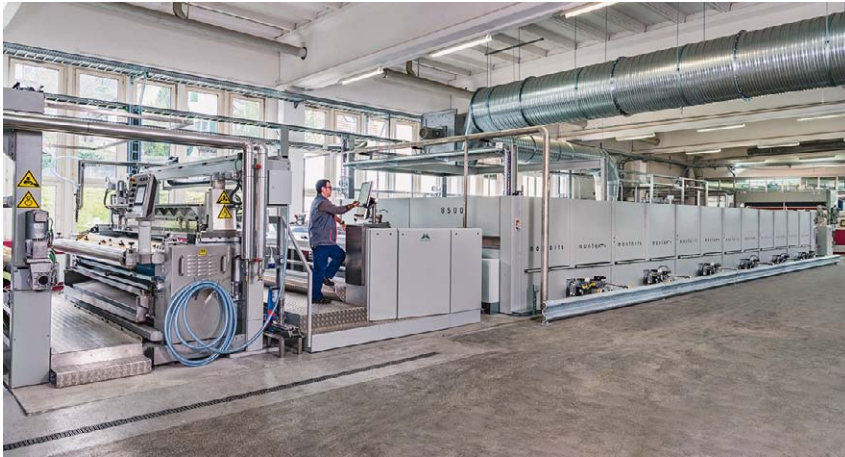
Sl.3 Jedan od dva Montex sušionika instaliranih u pogonu u Švicarskoj opremljen s posljednjom verzijom jedinice za naslojavanje texCoat
