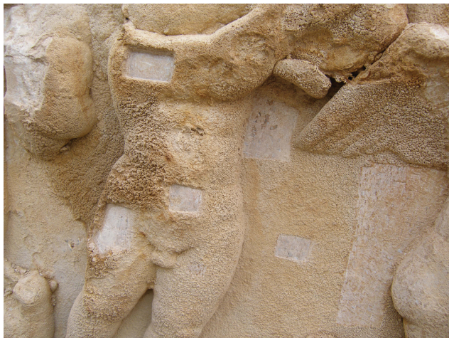
Sl. 2. Pokusno čišćenje debelih kalcitnih naslaga (foto: S. Bizjak)
