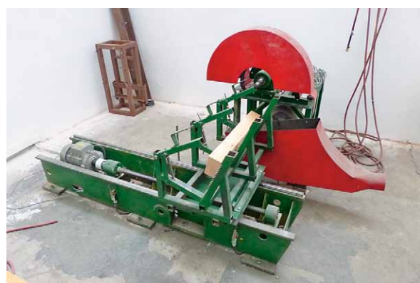
Figure 5 Measuring equipment for cross-cutting wood Slika 5. Stroj za eksperimentalno poprečno rezanje drva
