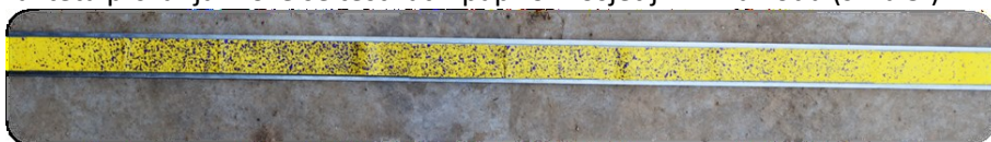
Slika 3. Papir osjetljiv na vodu postavljen na ciljana mjesta pokazuje kvalitetu depozita.
