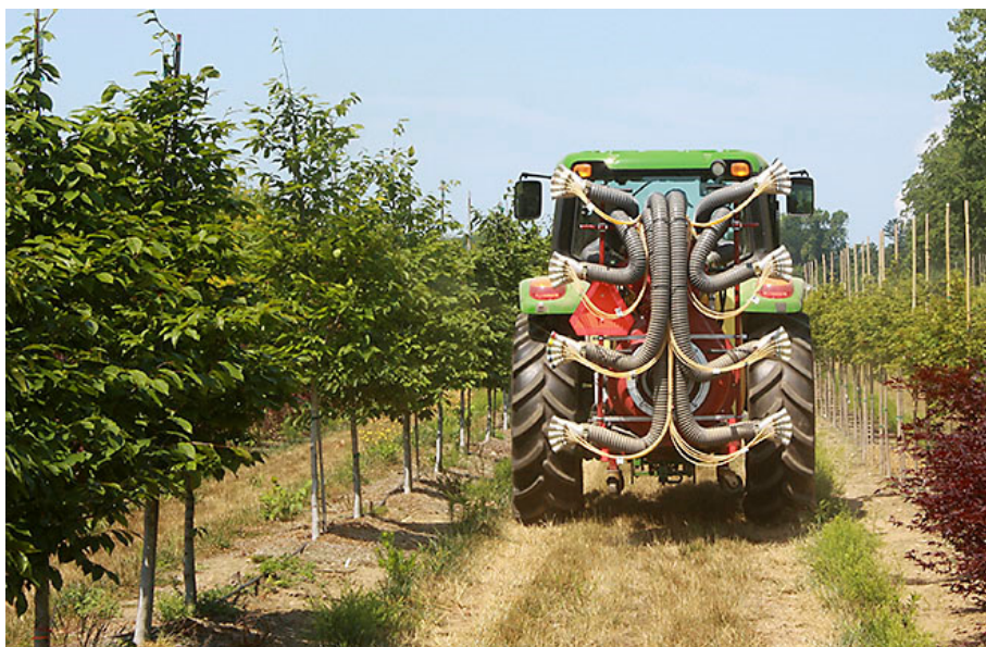
Slika 6. Traktor s orošivačem opremljenim novim sustavom za lasersko navođenje mlaza u voćnjaku (izvor: https://agresearchmag.ars.usda.gov/ )
