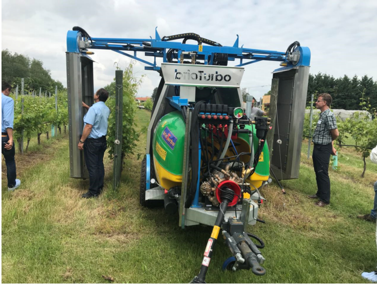
Slika 2. Tunelski orošivač s recirkulacijom SZB (snimila P. Pozder)
