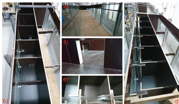
Slika 3: Fotografije fizičkog modela: hidraulički kanal (a); riblja staza bazenskog tipa – model (b) i detalj otvora (c); riblja staza s vertikalnim otvorima – model (d) i detalj otvora (e)
