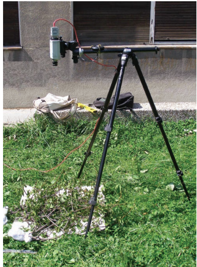
Slika 2. Snimanje hiperspektralnim linijskim skenerom ImSpector V9 (Ančić 2011)
