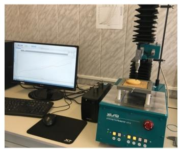
Figure 1. Texture analyzer «Structure meter ST-2»
