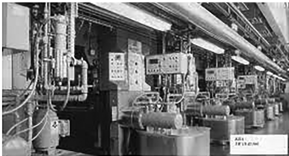
Sl. 5. a) Rotacija u dubokm tisku Rotoman, b) uređaji za odvođenje ishlapjelih sadržaja bojila 26
