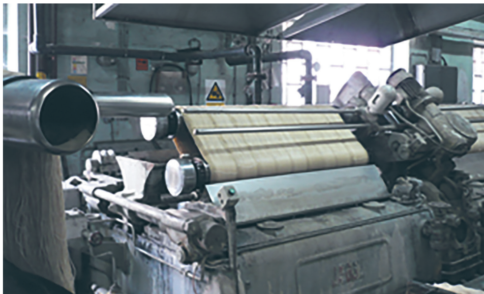
Sl. 23. Stroj za merceriziranje konca u Unitasu
