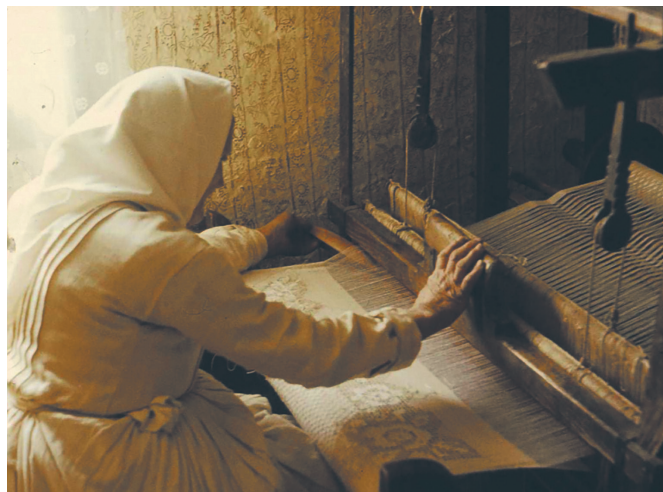
Sl. 3. Tkanje “na vutljak” na horizontalnom tkalačkom stanu [2]
