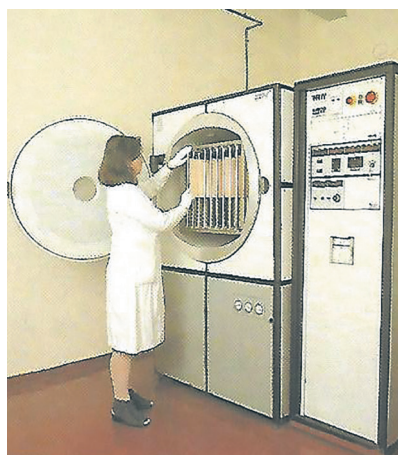
Sl. 21. Skidanje bakrenog srha u rupama tiskanih ploča tehnologijom “plasma etchinga” u pogonu na Grani [2]
