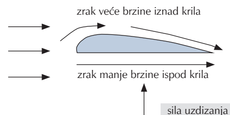
Slika 1 – Strujanje uz krilo slijedi Bernoullijevo načelo
