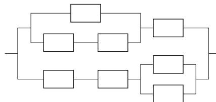
*Rješenje.* Donja grana sheme sastoji se od dva serijski spojena otpornika i paralelnog spoja dva otpornika desno, čiji je zajednički otpor  $R^2/(R+R) = R/2$ . Time je ukupan otpor donje grane  $R + R + R/2 = 5R/2$ . Paralelni spoj u gornjoj grani ima otpor  $R \cdot 2R/(R+2R) = 2R/3$ . Time je ukupan otpor u gornjoj grani  $R + 2R/3 = 5R/3$ . Paralelni spoj gornje i donje grane daje ukupan otpor:
