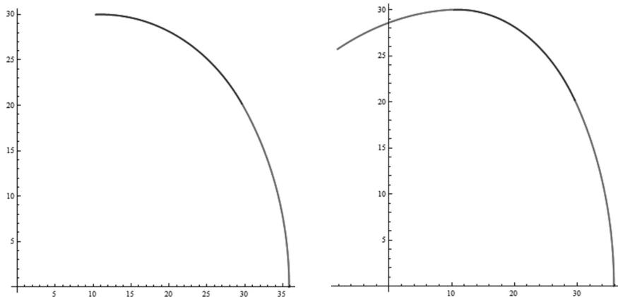
Primijetimo da, u slučaju kada je brzina jednog kotača cijelo vrijeme veća od brzine drugog, dobivamo neprekidnu „spiralu” sastavljenu od kružnih lukova kružnica, općenito različitih radijusa i središta. U vremenskim intervalima u kojima su brzine jednakе, kružni će lukovi biti zamjenjeni dužinama.
