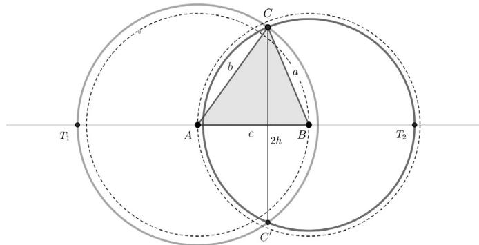
Presjeke ovih dviju kružnica označimo s  $C$  i  $C'$ . Povucimo simetralu dužine  $\overline{CC'}$ . Pomoću sjecišta ovog pravca i kružnica odredimo promjere ovih kružnica. Polumjeri kružnica odgovaraju duljinama stranica  $a$  i  $b$  (udaljenost vrha flomastera od točaka dodira lijevog i desnog kotača s podlogom). Duljinu stranice  $c$  (razmak između kotača) dobijemo oduzimanjem zbroja duljina ovih stranica od udaljenosti točaka  $T_1$  i  $T_2$ .
