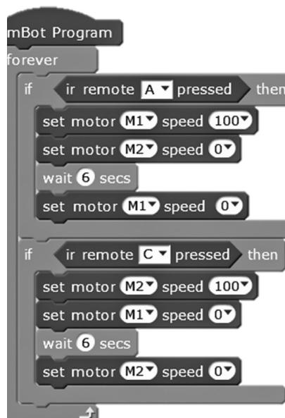
Višestruko ponavljanje naredbi omogućava nam beskonačna petlja `forever`. U klasičnom programiranju tzv. beskonačnu petlju spominjemo, nakon što uvedemo pojam petlje, više kao izuzetak, odnosno kao primjer pogreške. Prilikom programiranja mBota, beskonačna petlja gotovo se uvijek koristi budući da robot obično treba odgovarati na vanjske podražaje tijekom duljeg razdoblja.
