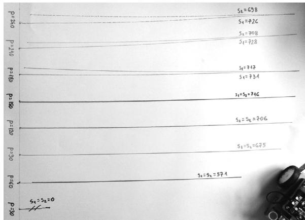
Na slici možemo vidjeti da se pri manjim brzinama (150, 120, 90 i 60) robot vratio u početnu točku, dok se pri većim brzinama točka povratka značajnije razlikovala od početne točke.
