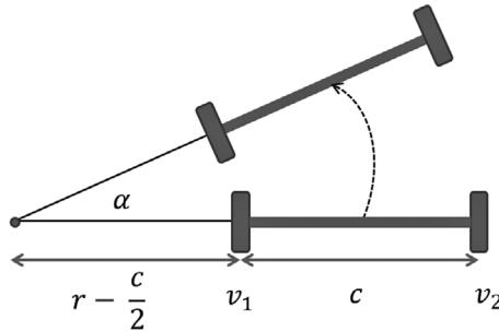
Nakon vremenskog intervala  $\Delta t$  dolazi do promjene barem jedne od brzina. Sjedište pravaca na kojima leže spojnice na početku i na kraju drugog vremenskog intervala bit će neka točka u ravnini, različita od ishodišta.
