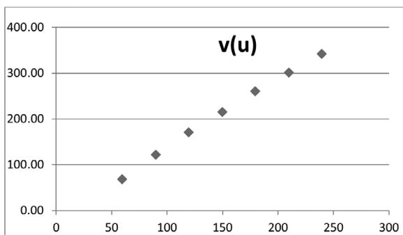
Promatranjem ovoga grafa možemo uočiti da točke grafa leže približno na pravcu, odnosno da su ulazna brzina motora i brzina kretanja robota povezane linearnom funkcijom.
