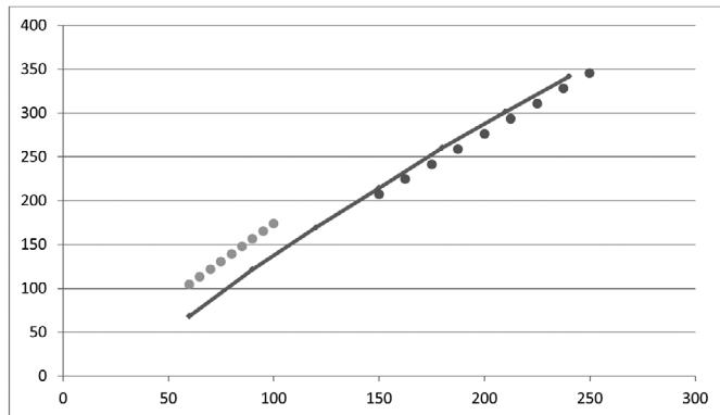
Možemo primijetiti da se, kod gibanja po kružnici, za istu ulaznu brzinu motora sporiji kotač giba nešto brže nego za istu ulaznu brzinu motora kod pravocrtnog gibanja, dok se brži kotač giba nešto sporije nego što bi se gibao kod pravocrtnog gibanja.
