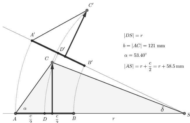
Omjer polumjera kružnica jednak je, prema ranijem razmatranju o šestaru s dvije olovke, omjeru brzina kotača.  $\left(r - \frac{c}{2}\right) \cdot \alpha = v_2 \cdot t$  i  $\left(r + \frac{c}{2}\right) \cdot \alpha = v_1 \cdot t$ . Dijeljenjem
