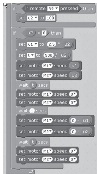
Izvođenje ovog programa, odnosno crtanje kružnica s različitim brzinama motora (uvijek istog omjera 1 : 2.5) prikazano je na video snimci:
