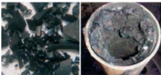
Slika 2. Asfaltene. Laboratorijski uzorak asfaltene iz nafte (lijevo); začepljenje cijevi uzrokovanih asfaltenima (desno)
