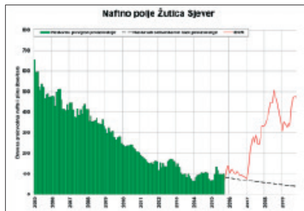
Slika 20. Grafički prikaz dnevne proizvodnje nafte i plina na EPU Žutica sjever od 2005. do 2019.
