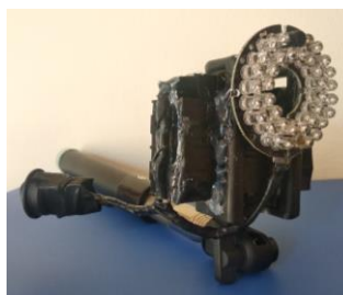
Slika 5. Učenička konstrukcija infracrvenog LED osvjetljenja
