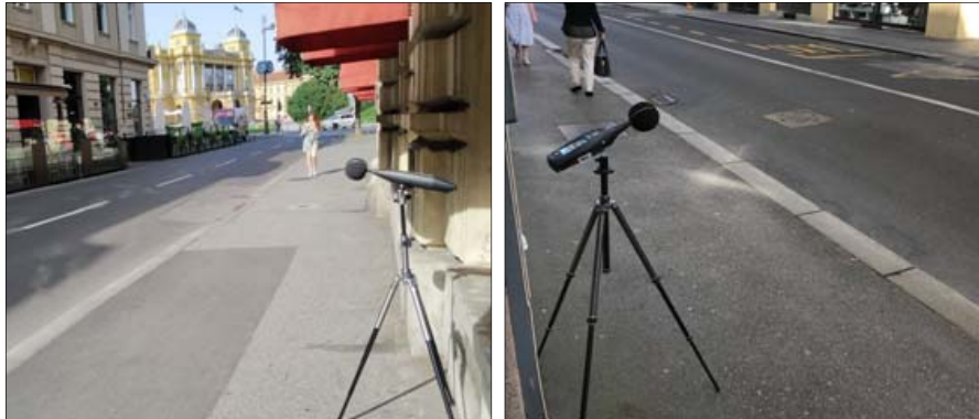
Slika 3. Mjerenje razina buke u Masarykovo ul.: MM1 (lijevo), MM2 (desno)
