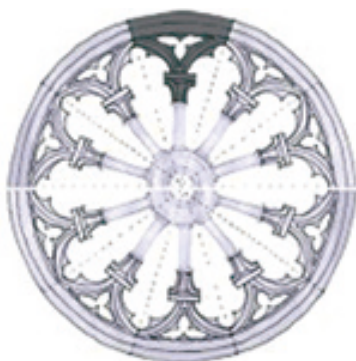
Rozeta stare gotičke hvarske katedrale. Rekonstrukcija po fragmentu u vrtu hvarske biskupije.
