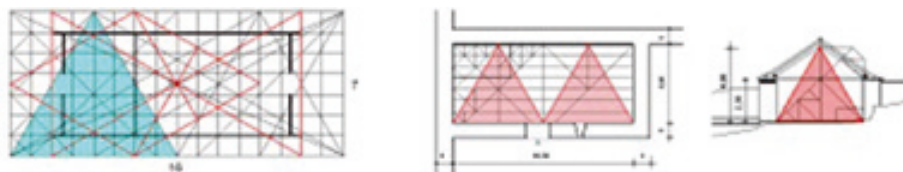
Schema tlocrta Partenona u proporciji 16 : 7, u kojeg se upisuju dva istostranična trokuta (lijevo) i tlocrt i presjek kuće u polju Krivoci. Projekt rekonstrukcije Ivo Štambuk, dia (desno).
