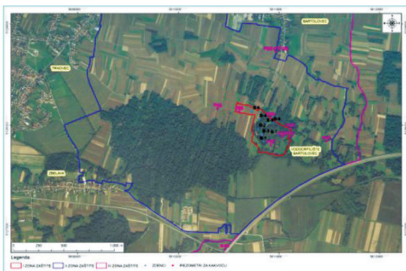
Slika 1: Vodocrpilište Bartolovec s označenim zonama zaštite, zdencima i piezometrima (Posavec i Bačani, 2016.)
