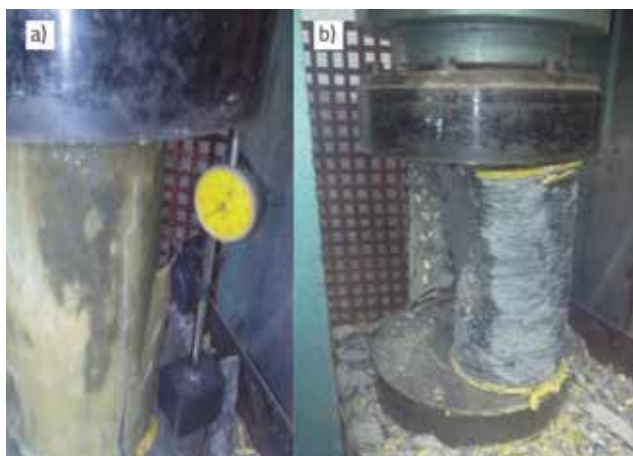
Slika 19. Načini i oblici sloma ispitanih uzoraka: a) ovijen GFRP-om; b) ovijen CFRP-om
