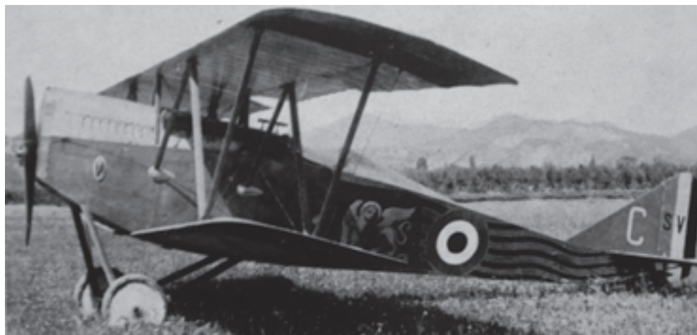
Ill. 8 - Aereo biplano monoposto (ricognitore armato) Ansaldo S.V.A. 5 (dal vol. 87.a Squadriglia "La Serenissima", cit., p. 38, Ufficio storico A.M.).
